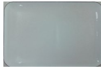
④ 別工程にて絵皿の形状に成形した銅素地に珪瑯を施し焼成する
