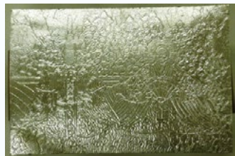
⑤ ③の原版で純銀箔（0.01mm厚）に模様をプレスする
